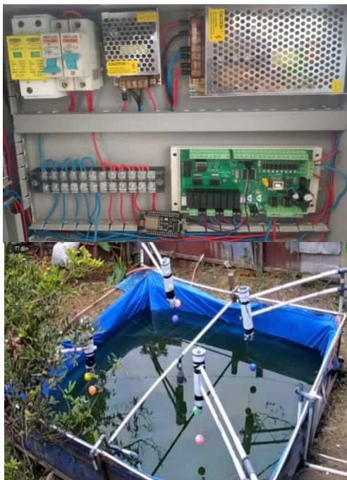
Gambar 5. Tampilan Alat Kendali dalam Panel dan Mekanisme yang Dikendalikan di Kolam Komponen kontrol perangkat keras disimpan dalam sebuah panel, sedangkan perangkat keras output
